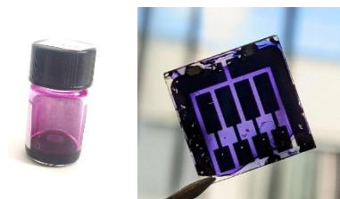
Figure 1: Encres colloïdales aqueuses de semiconducteurs organiques et cellule OPV fabriquée à partir d'une encre aqueuse
